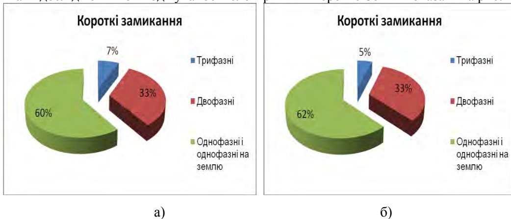
Рис. 1. Пошкоджуваність мереж 6-10 кВ (а) 35 кВ (б).
