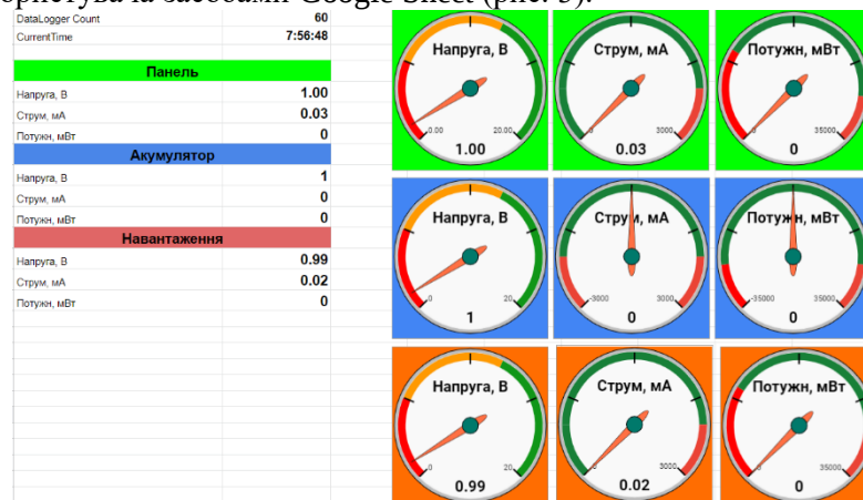
Рис. 3 – Графічний інтерфейс користувача інформаційно-вимірювальної системи
