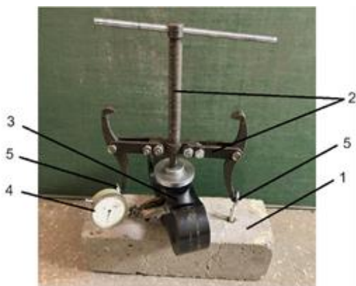
Рис. 2. Установка для статичного навантаження 1 –зразок; 2 –силовий механізм; 3 –динамометр; 4 –індикатор годинникового типу; 5 –клиновий анкер
