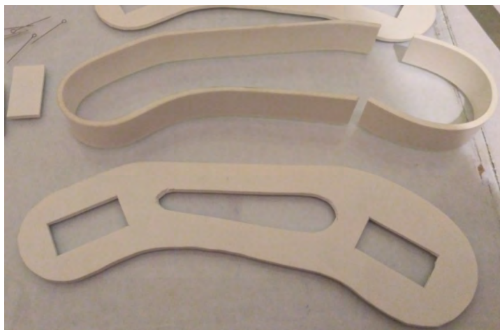
Рисунок 1. – Заготовки майбутнього плеча маніпулятора з пінополістиролу
