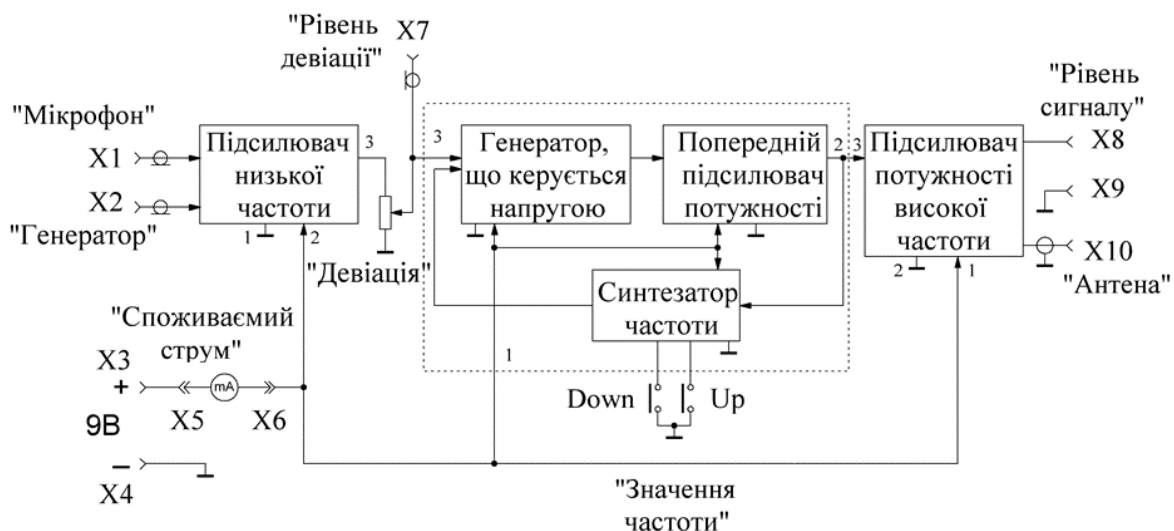
Рис. 1. Структурна схема ЧМ передавача
