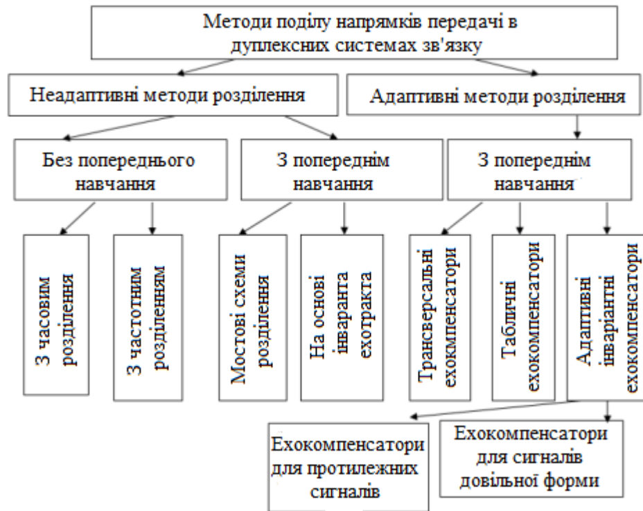
Рисунок – 1. Класифікація компенсаційних методів поділу напрямків передачі в дуплексних системах зв'язку
