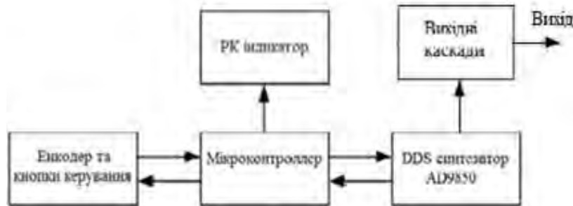
Рисунок 2 – Генератор випробувальних сигналів
