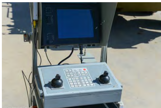
Рис. 1. Приклади конструкції пультів керування дистанційно керованих пристроїв
