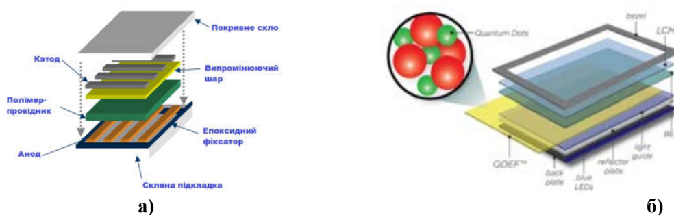
Рисунок 1 – а) типова структура OLED пристрою; б) типова структура QLED пристрою
