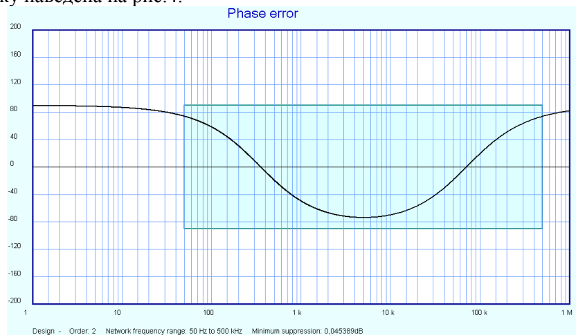
Рис. 4. Фазова помилка для активного фільтру 2-го порядку
