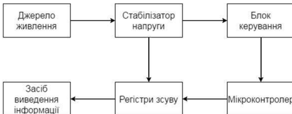
Рис.1. Пристрій для завантаження міні-ігор на основі мікроконтролера PIC16F688
