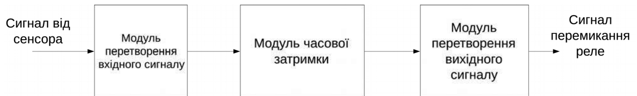
Рис. – Структурна схема пристрою контролю визначення заповненості контейнера
