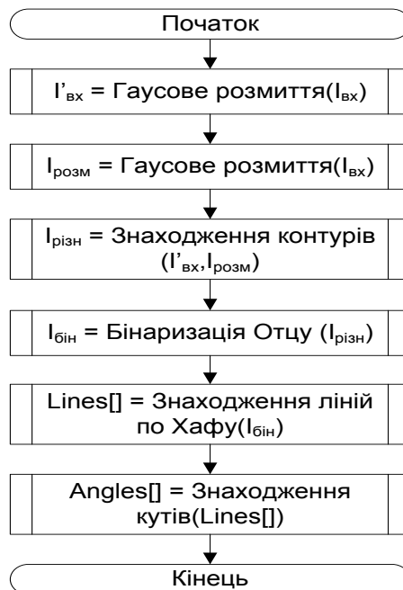
Рис. 7 Блок-схема роботи детектора визначення кутових параметрів малогабаритних об'єктів складної форми
