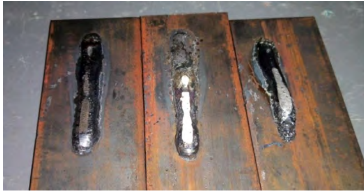
Рисунок 2 – Зразки після вимірювання твердості
