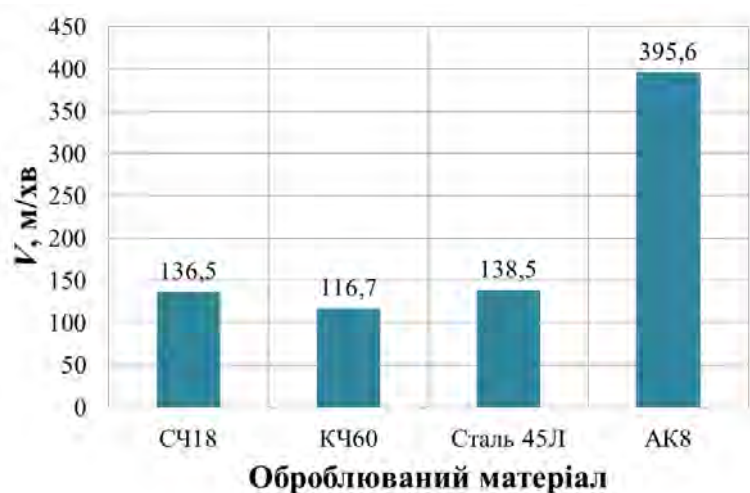
Рис. 2. Вплив матеріалу заготовки деталі типу «Корпус» на оптимальне значення швидкості різання
