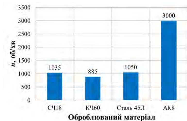
Рис. 3. Вплив матеріалу заготовки деталі типу «Корпус» на оптимальне значення частоти обертання шпинделя
