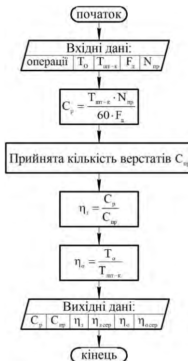
Рис. 1. Блок-схема алгоритму розрахунку кількості обладнання на дільниці (в цеху) механічної обробки
