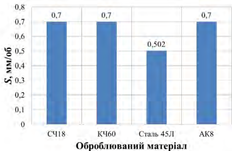
Рис. 1. Вплив матеріалу заготовки деталі типу «Корпус» на оптимальне значення подачі
