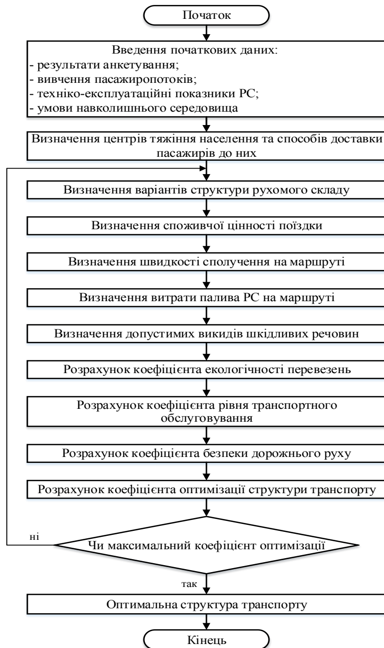
Рисунок 1 – Алгоритм визначення оптимальної структури рухомого складу
