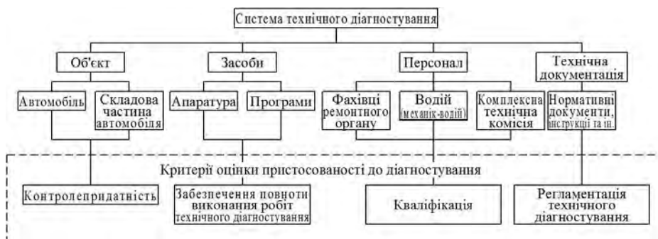
Рис. 1. Складові системи технічного діагностування автомобілів в агропромисловому комплексі
