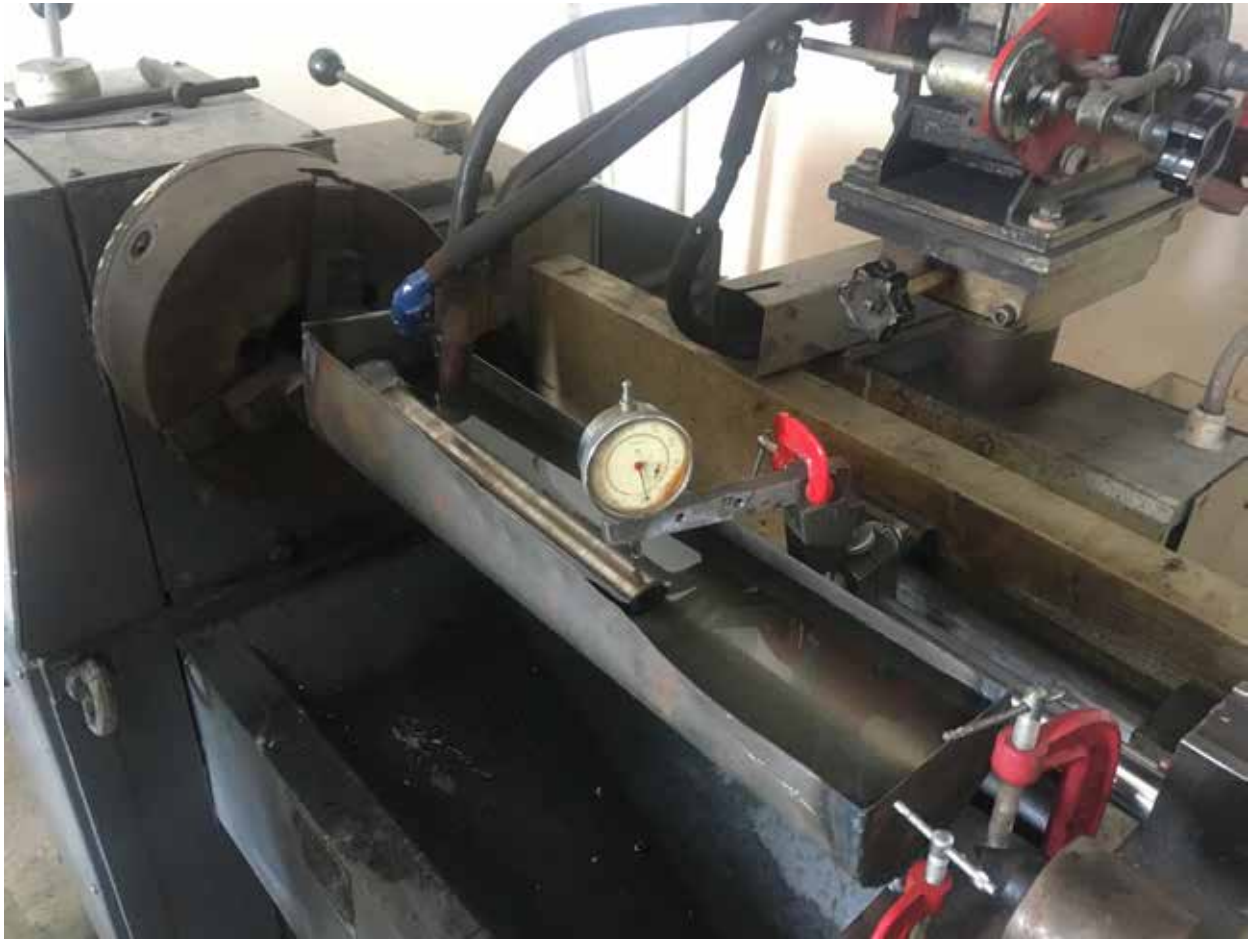
Рис.1. Установка для мокрого наплавлення.
