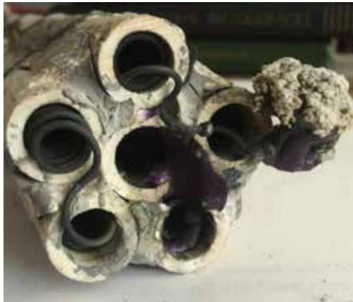
Рисунок 4 – Загальний вигляд перегорілої спіралі діаметром 1 мм.
