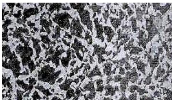
Рисунок 3 – Мікроструктура покриття отриманого з використанням наплавочного дроту Нп-30ХГСА (x200)
