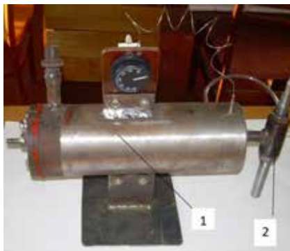
Рис. 1. Дослідна установка для газодинамічного нанесення функціональних покриттів: 1 – нагрівач повітря, 2 – головка для напильовання
