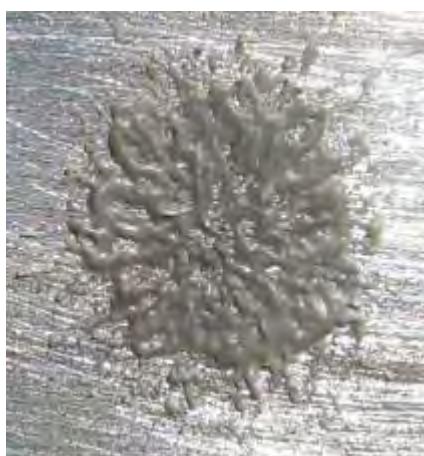
Рис. 4. Результати напилення температура повітря 350 °С. Попередній прогрів підкладки 200 °С.
