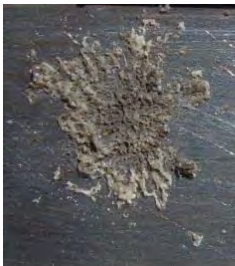
Рис. 3. Результати напилення температура повітря 300 °С. Попередній прогрів підкладки 100 °С.
