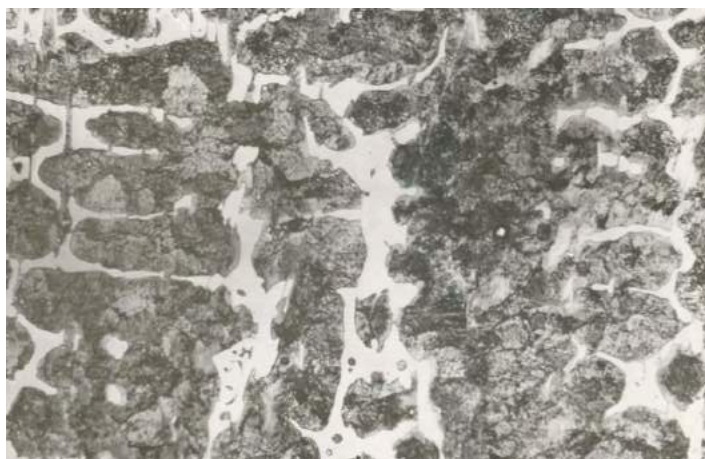
Рис. 2 – Мікроструктура поверхневого шару при двошаровому наплавленні. (x500)
