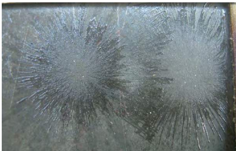
Рис. 5. Результати напилення температура повітря 450 °С. Попередній прогрів підкладки 300 °С.
