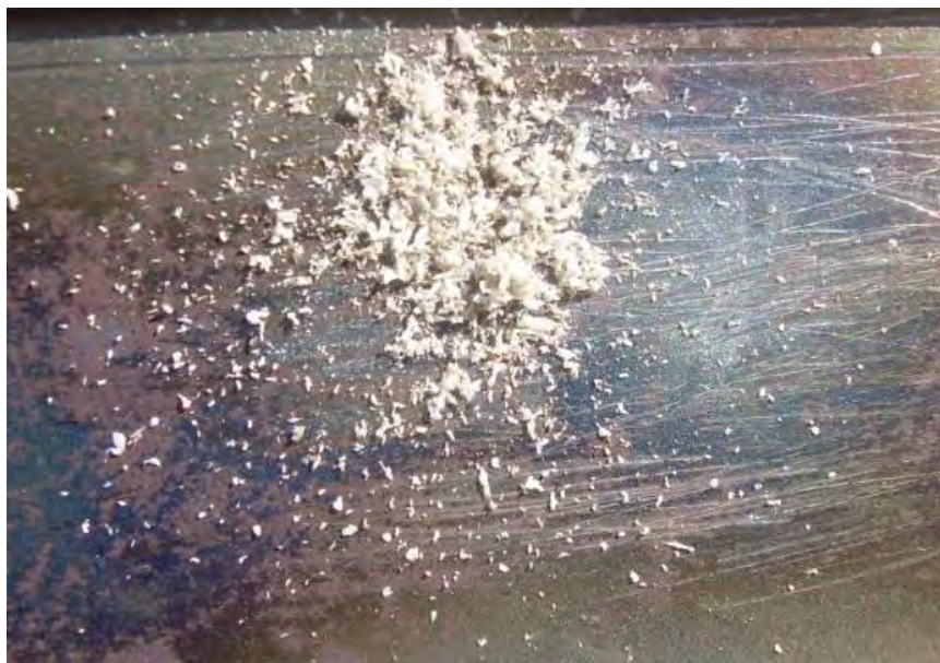
Рис. 2. Результати наплення температура повітря 200 °С. Попередній прогрів підкладки 40 °С.
