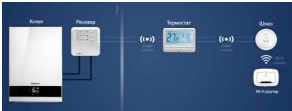
Рис. 1. Автоматизована система управління індивідуальним опаленням
