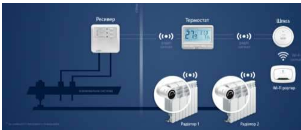
Рис. 2. Автоматизована система управління централізованим опаленням
