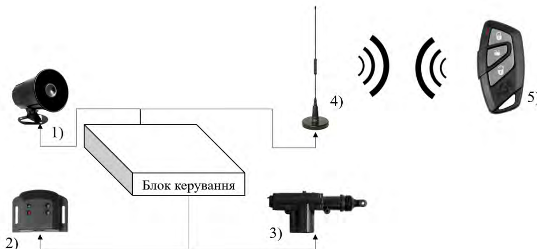
Рис. 1. Узагальнена схема автомобільної сигналізації
