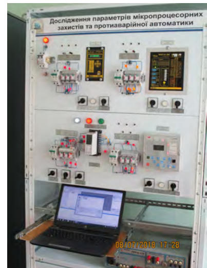
Рис.1. Зовнішній вигляд лабораторного стенду для дослідження параметрів мікропроцесорного захисту та протипаралельної автоматики
