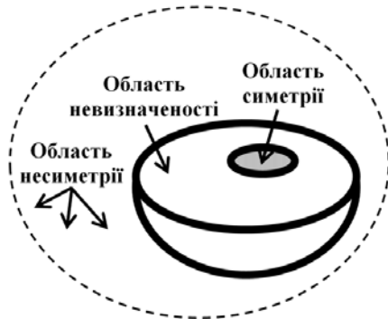
Рис. 2 Структура координатного простору комплексу діючого значення напруги зміщення нейтралі
