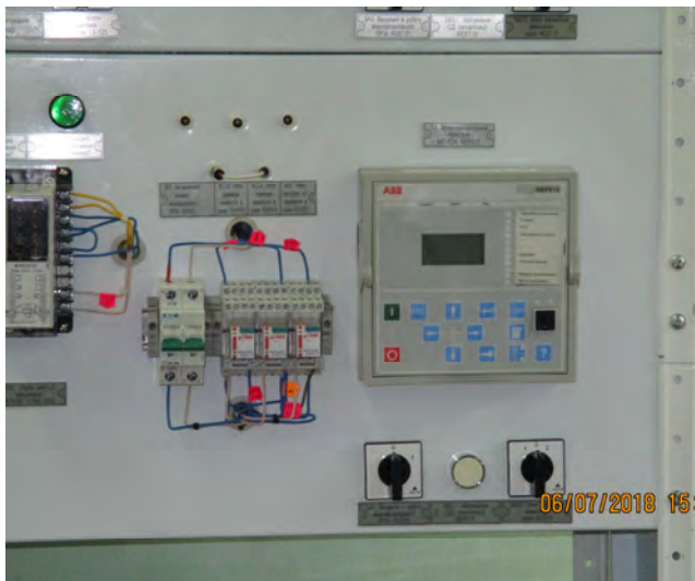
Рис.1. Зовнішній вигляд лабораторного стенду для дослідження параметрів мікропроцесорного захисту та протипаралельної автоматики
