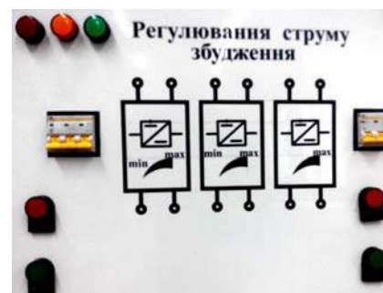
Рис. 1. Блок для регулювання струму збудження
