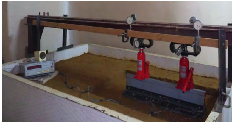
Рис. 1 – Випробування моделі стрічкового пальового фундаменту
