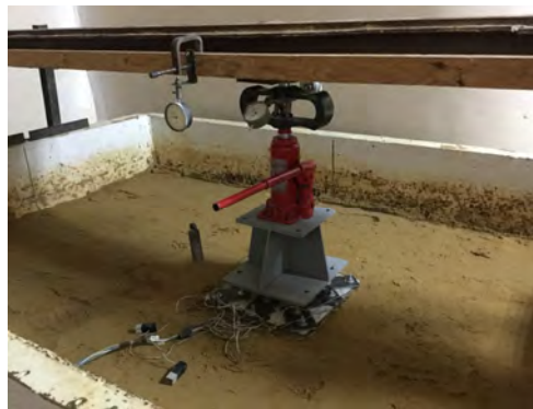
Рис. 2 – Випробування моделі стовпчастого пальового фундаменту
