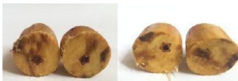
Рисунок 2 – Поперечний розріз зразків насичених імпульсним способом
