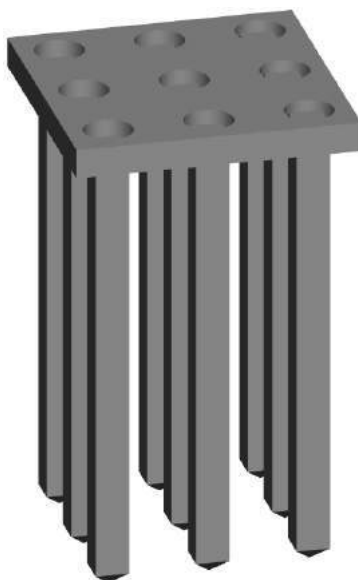
Рис. 1 – Об'ємне зображення моделі пального фундаменту при кроці паль 3d
