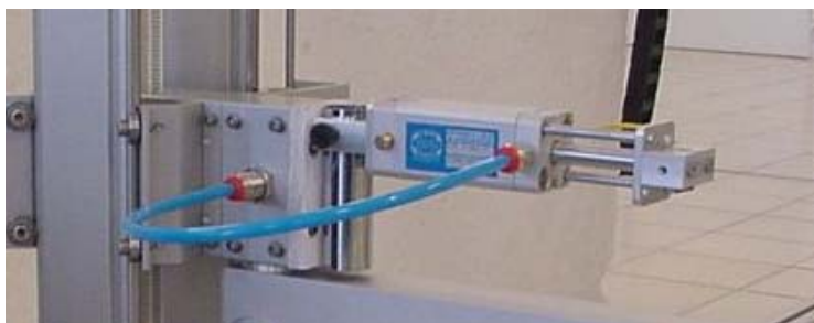
Рис. 2 Забезпечення натягу дроту за допомогою пневматичної системи
