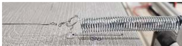
Рис. 1 Забезпечення натягу дроту за допомогою пружини
