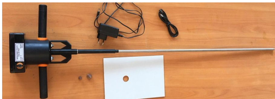
Рис.1`. Пьезоелектричний пенетрометр з конусним наконечником під вимоги НАТО
