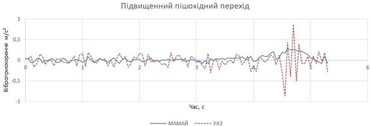
Рис.2. Порівняльні графіки віброприскорень на місці водія при переїзді підвищеного пішохідного переходу згідно ДСТУ 4123:2020 з швидкістю 30 км/год (проїзд переходу – 4-5 секунди)
