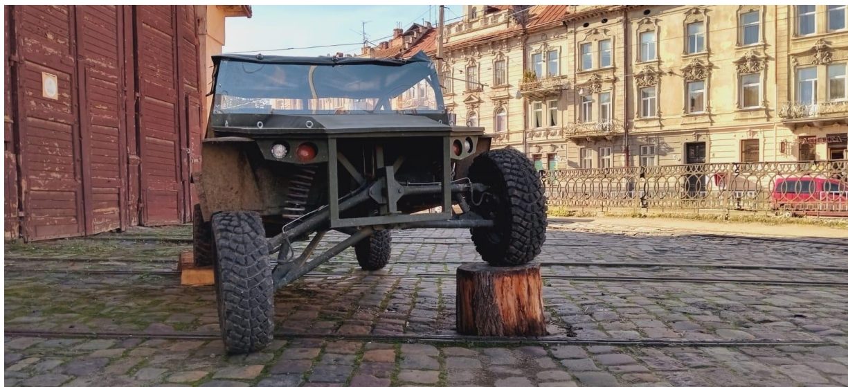
Рис. 1. Незалежна довгоходова підвіска легкого ударного автомобіля переднього краю – military buggy LTV 02 «Мамай»
