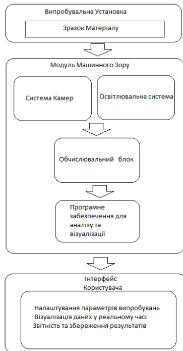
Рис. 1. Принципова функціональна схема виміральної системи на базі машинного зору для дослідження імпульсних навантажень на випробувальних машинах
