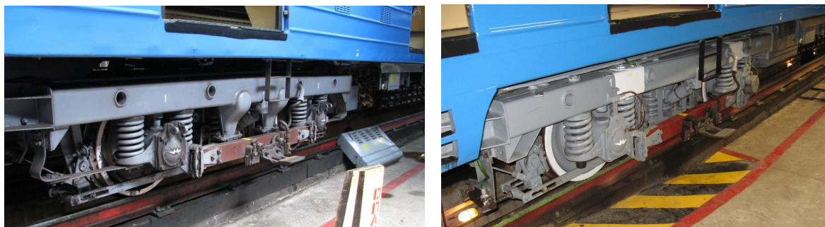
Рис. 1. Візки вагону метрополітену: а – повідцевий, б - шпінтонний
