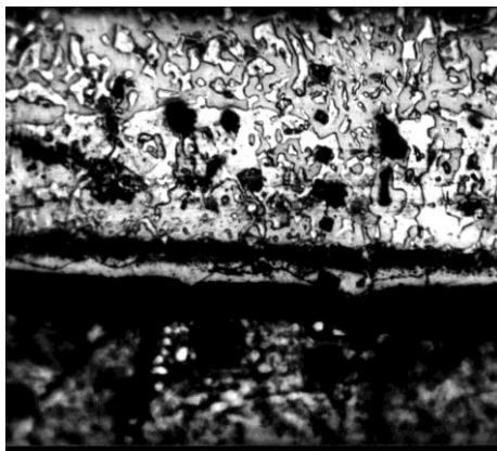
Рис. 1. Мікроструктура дифузійного шару на сталі У 10 з попереднім Ni–Co–P покриттям. Режим: T=1050^{\circ}\text{C} , витримка \tau=7 год. (ізотермічна витримка \tau=1 год. при T=800^{\circ}\text{C} ).
