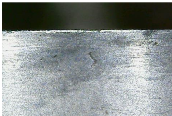
Рис. 1. Контактна ділянка задньої поверхні зразка (ШХ15 58 HRC, v = 215 м/хв, S = 0,1 мм/об, t = 0,2 мм, h_z = 0,05 мм, T = 5 хв)
