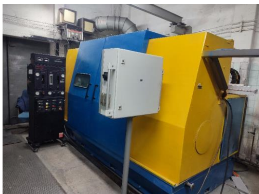
Рис. 1. Плазмова установка Metco 9MC.
