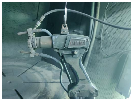
Рис. 2. Плазмотрон установки Metco 9MC.
