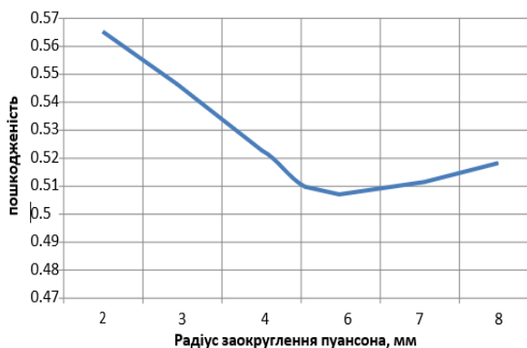
Рисунок 3 – Залежність пошкодженості матеріалу від радіуса заокруглення пуансона
