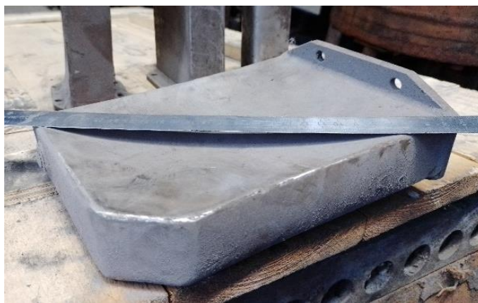
Рис. 3. Деформовані (вогнуті) стінки бачка кристалізатора
