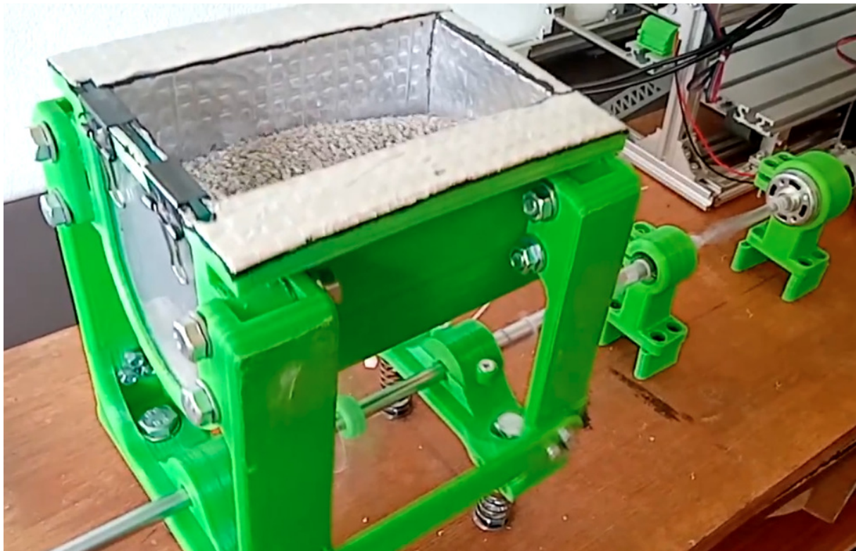
Рис.1. Лабораторна установка вібраційної обробки
