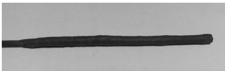
Рисунок 1 – Електрод з обмазкою МНЧ-2 з додаванням 1% молібдену.
