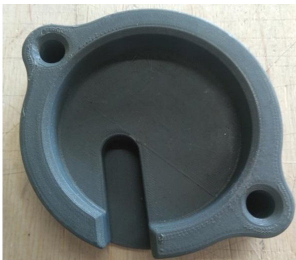
Рис.1. Пластиковий аналог тримача для втулки, надрукований на 3д принтері
