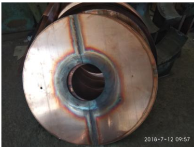
Рисунок 2 - Вигляд листових заготовок під обкочування
