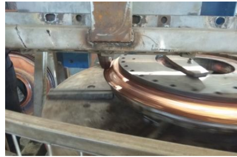
Рисунок 3 - Процес формування методом ШО зовнішнього фланця кришки бражної колони
