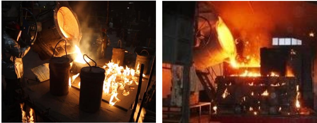
Рис. 2 – Горіння газу на формі від газифікації моделі.
