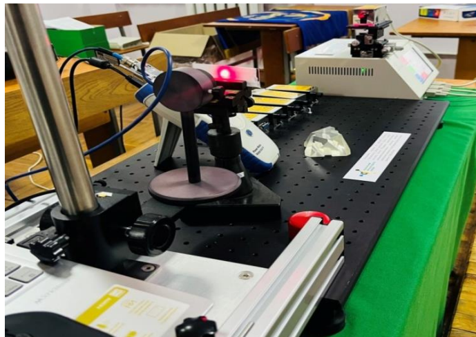
Рисунок 1 – Лазерний стенд для визначення коефіцієнту поглинання біотканини в ІЧ (830 нм) та червоному (658 нм)
