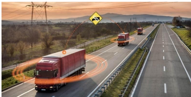
Рис. 1. Вигляд руху автотранспортних засобів у колоні із використанням технології «платунінг»
