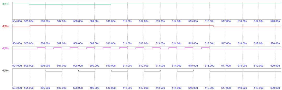
Рис. 3 (а). Часові діаграми роботи перетворювача ємність - часовий інтервал – двійковий код при ємності C_x=1\text{нФ}
