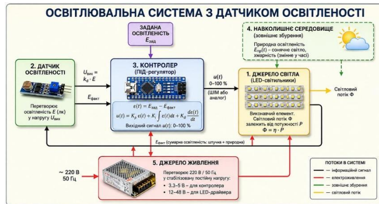
Рисунок 1 — Схема освітлювальної системи з датчиком освітленості
