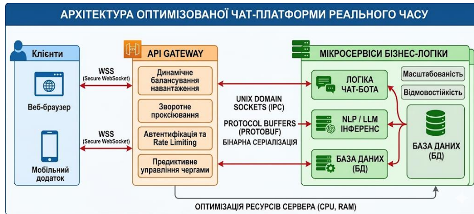
Рисунок 1. Схема архітектури оптимізованої розподіленої чат-платформи реального часу.
