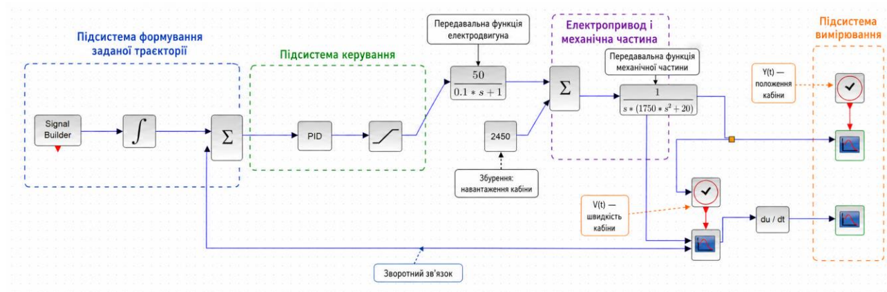
Рисунок 3 - Схема імітаційної моделі у середовищі Scilab/Xcos
