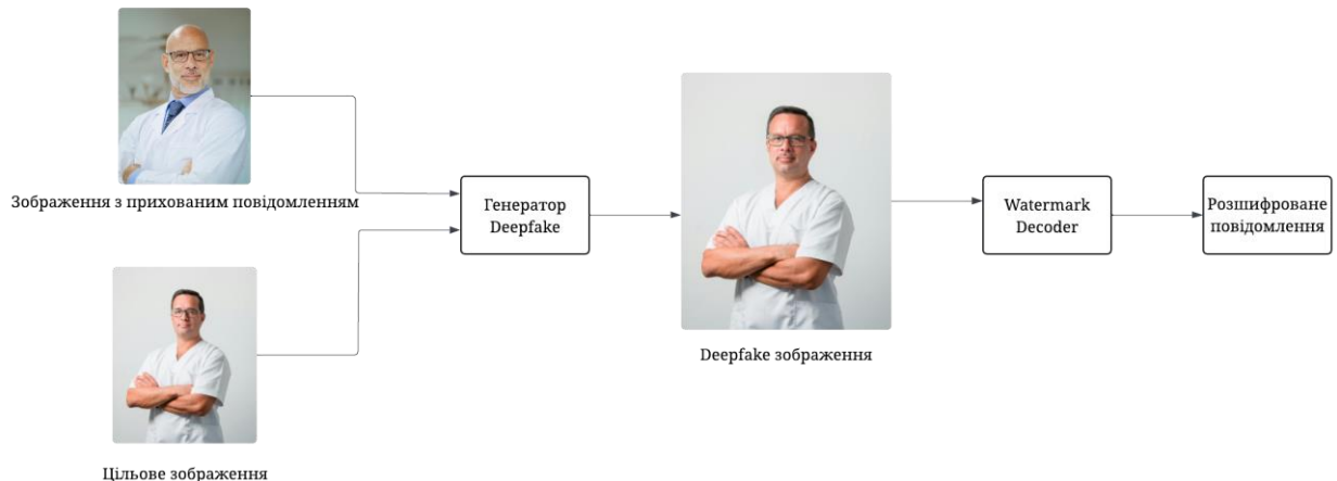
Рис 3. Архітектура штучної нейронної мережі для видобування повідомлення в зображенні
