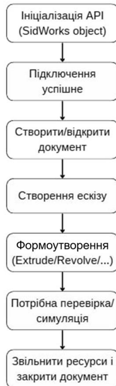
Рис. 1. Блок-схема алгоритму автоматизованого проєктування через SOLIDWORKS API
