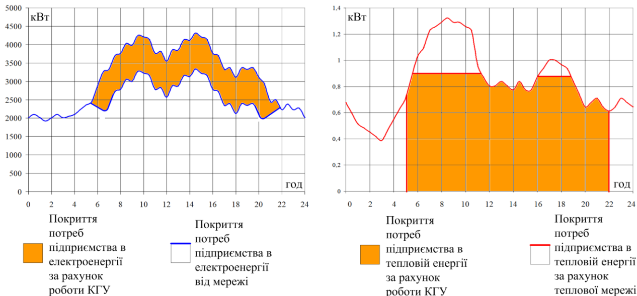
Рис. 1. Середньозважений добовий графік покриття споживання електричної та теплової енергії підприємство від КГУ та мережі
