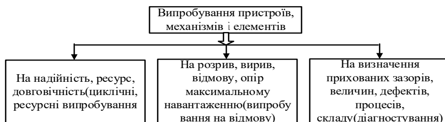
Рисунок 1 - Типи випробувань пристроїв, механізмів і елементів
