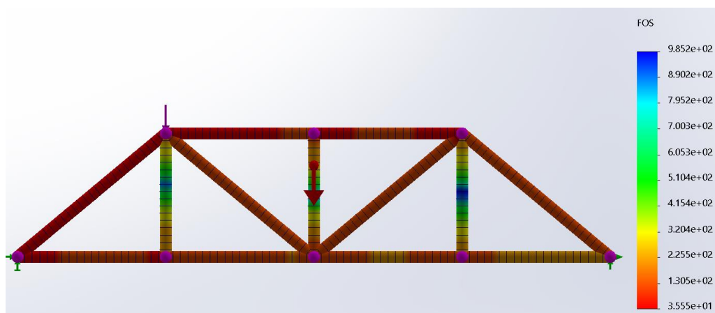
Рис. 4. Епюра розподілу коефіцієнта запасу міцності
