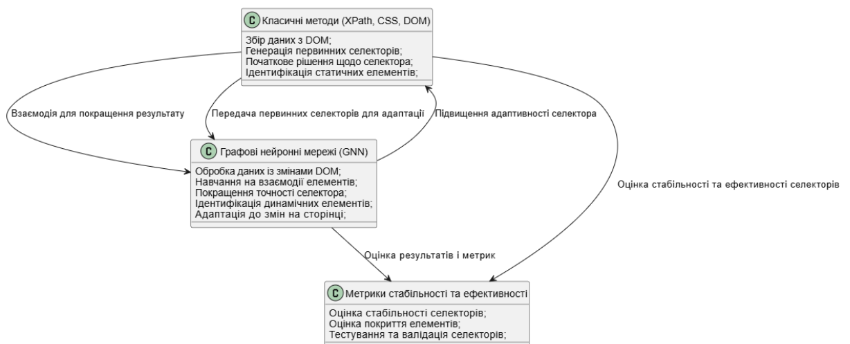
Рисунок 1 – Діаграма процесу поєднання графових нейронних мереж (GNN) з класичними методами вибору селекторів (XPath, CSS, DOM)
