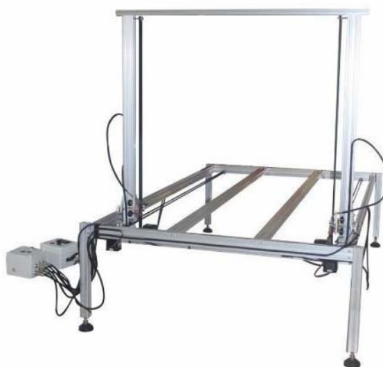
Рис. 1 - Конструкція дровіх верстатів з числовим програмним керуванням
