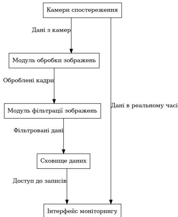
Рис. 1. Структура роботи підсистеми відеоспостереження з модулем фільтрації зображень
