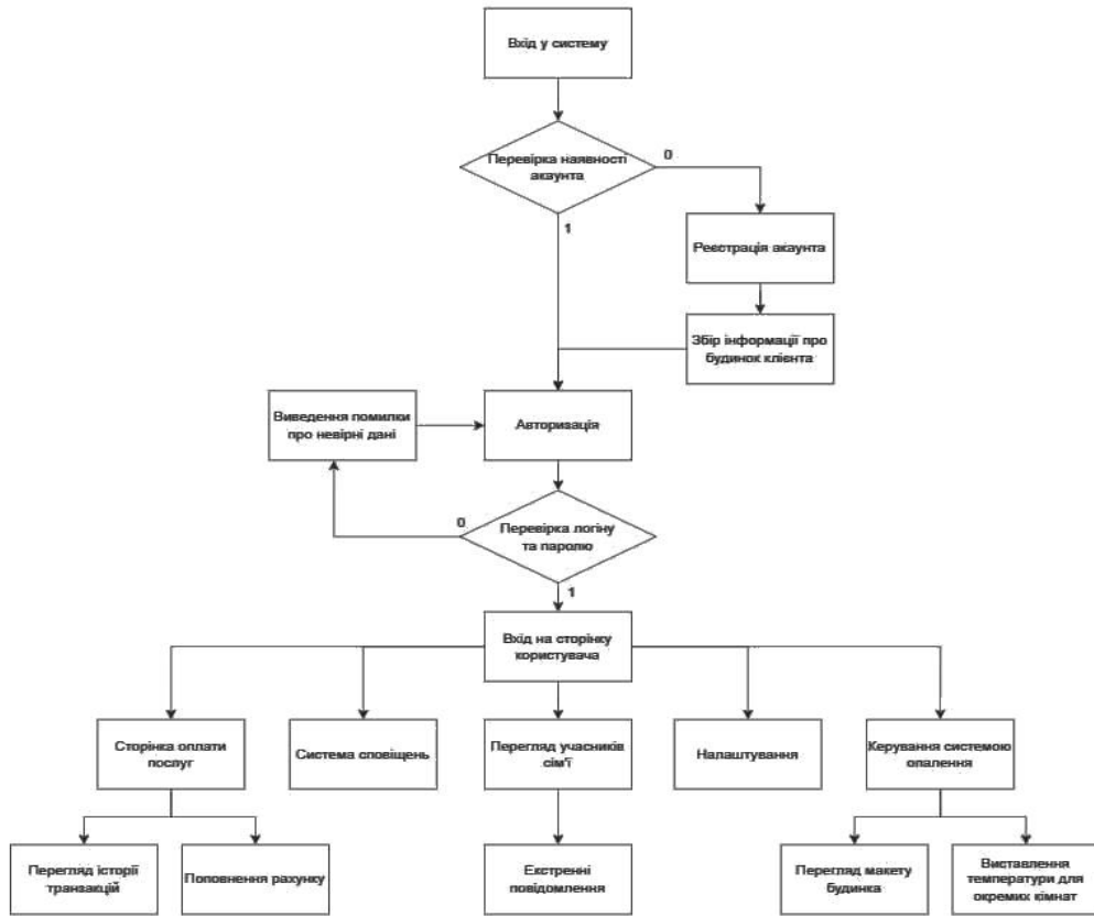
Рис. 1. Структура системи дистанційного керування системою опалення
