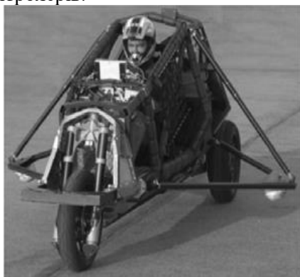
Рис. 3. Прототип дельта-моделі (вузький автомобіль з можливістю нахилу)
