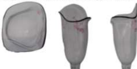
Рис. 5. Різновиди конструкції куксоприймальної гільзи при трансфеморальній ампутації
