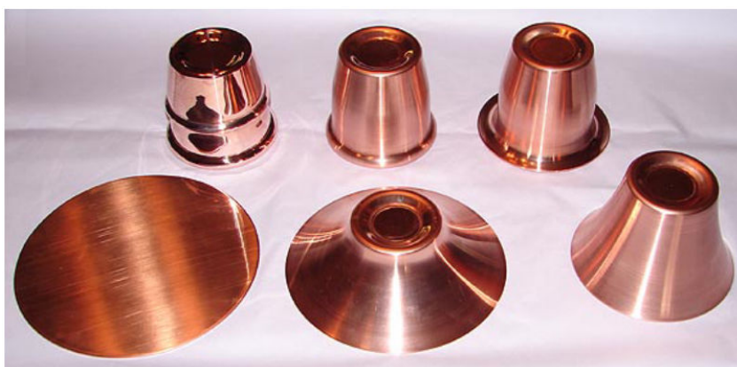
Рис. 1. Етапи формоутворення деталей, що виготовляються ротаційною витяжкою
